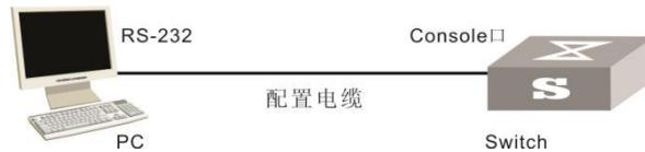
图 1.1 串口的连接
