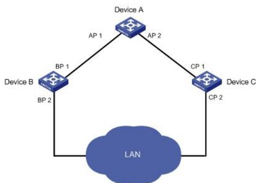
图 13.1 指定桥与指定端口示意图
