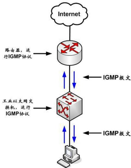
图 6.3 实现 IGMP Snooping 示意图
