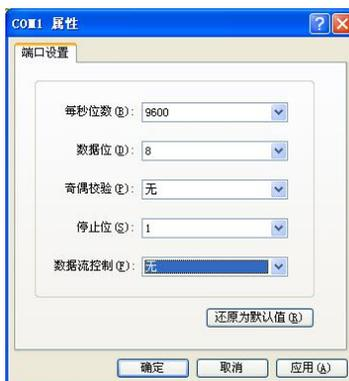
图 2.4 通讯端口参数设置
