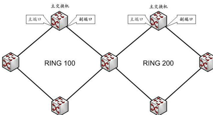
图22.2 相切在传输节点的相切环
