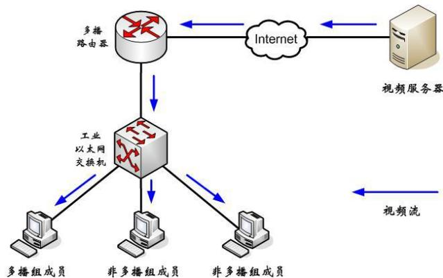
图 6.1 没有 IGMP Snooping 时组播报文传播过程
