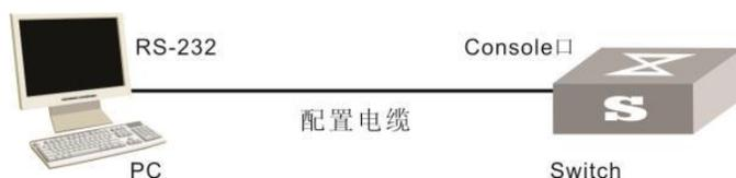
图 2.1 串口的连接
