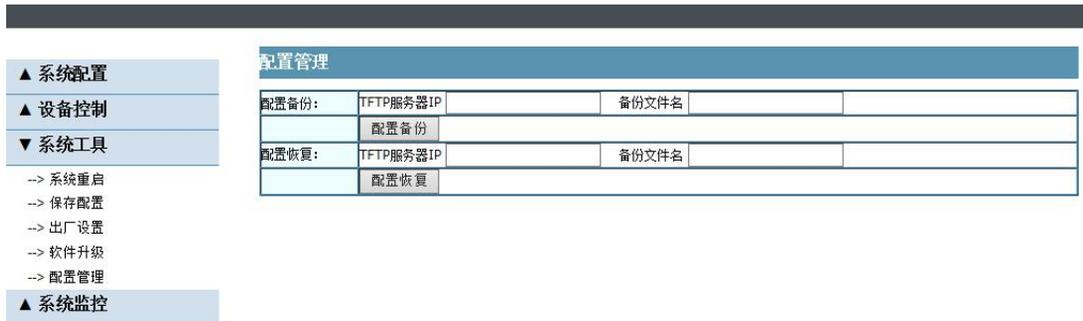
配置管理也需要 TFTP Server 的支持，配置备份就是将存储在 flash 中的配置文件上传到 TFTP Server 中；配置恢复就是将 TFTP Server 中的配置文件下载到 flash 中。
