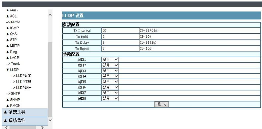
本页面用于设置 LLDP 的传输延时、发送间隔、重新初始化时间间隔和 LLDP 端口的模式等。
