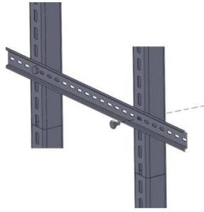
图 2.1 安装导轨
