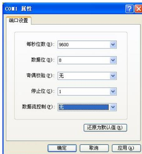
图 3.4 通讯端口参数设置
