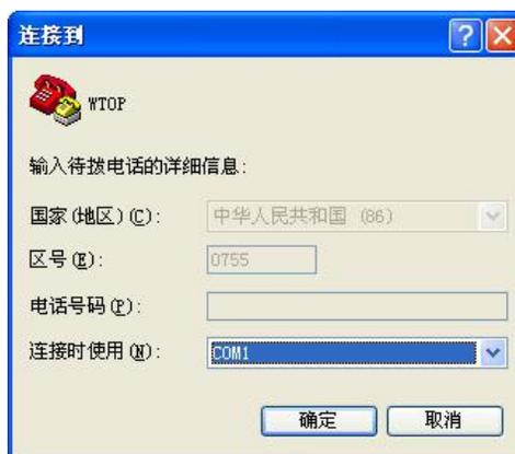
图 3.3 连接端口设置
