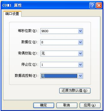
图 2.4 通讯端口参数设置
