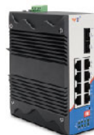
RS6310-2GF8GT-8POE 2 千兆 SFP 光口 + 8 千兆 POE 电口
